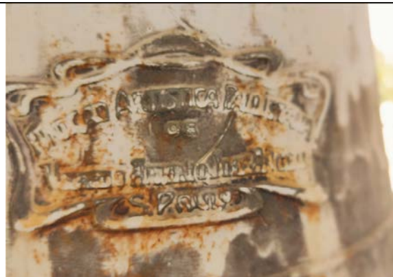
Foto 3: Marca localizada na lateral do sino, apresentando manchas brancas e oxidação. Fonte: Alex Alves, 26 de setembro de 2024.
