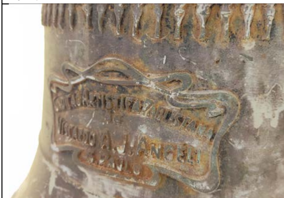
Foto 5: Detalhe de uma marca na superfície do sino, apresentando sinais de oxidação, que podem comprometer a sonoridade e a durabilidade do objeto. Fonte: Alex Alves, 26 de setembro de 2024.
